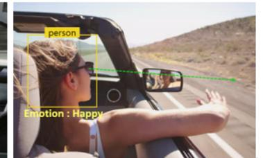
자율 주행 속도 제어 판단부는 탑승자 행위 인식부와 탑승자 감정 인식부에서 검출된 탑승자 상태를 토대로 자율 주행 중인 차량의 속도 제어가 필요하다고 판단되는 경우, 탑승자 상태 정보와 함께 자율 주행 속도 제어 요청을 자율 주행 제어부에 전송한다. 자율 주행 속도 제어 판단부로부터 속도 제어 요청을 받은 자율 주행 속도 제어부는 자율 주행 환경 검출부에 속도 제어 가능 여부를 확인하기 위해 요구되는 정보를 전송해줄 것을 요청한다.
